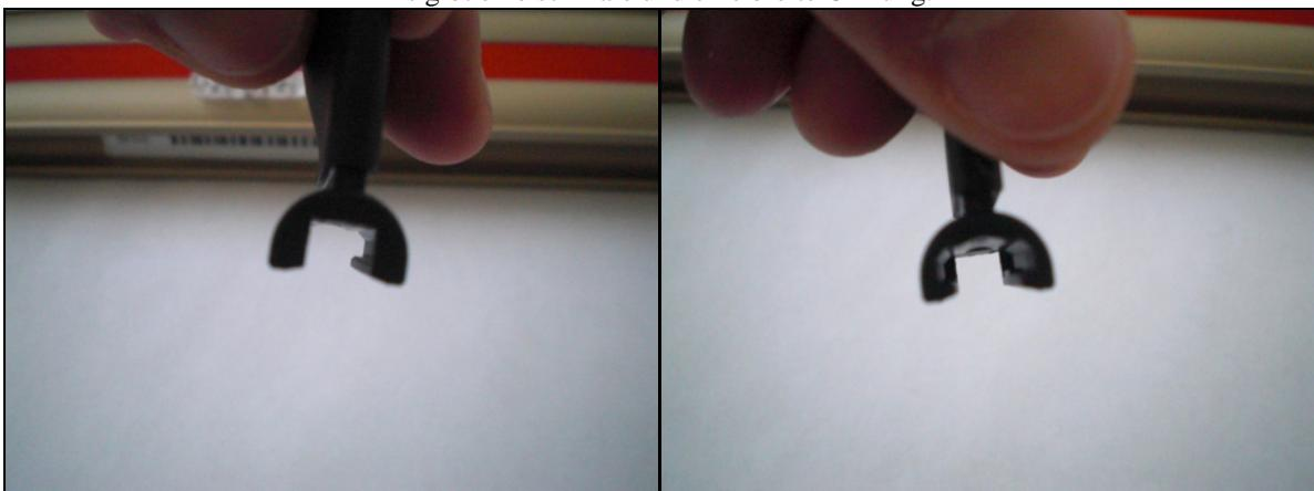
Die Griffe werden an der breiten Öffnung über die Halterung geschoben.
